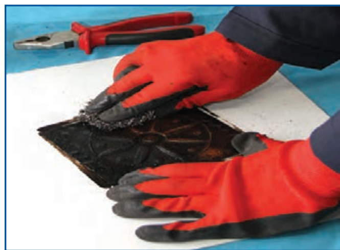
شکل ۱۱-۱۱- ساب زدن سطح پلاک مسی
