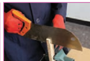
ث - اره کاری شیار بازوی چوبی
