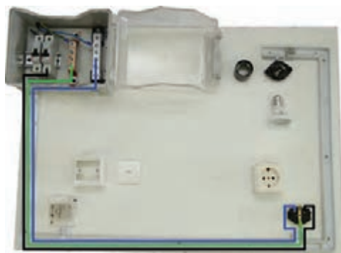
شکل ۱۰-۶- انجام سیم‌کشی پریز ۱
