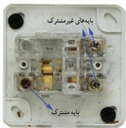
شکل ۶-۱۹- نمای داخلی یک نمونه کلید تبدیل
