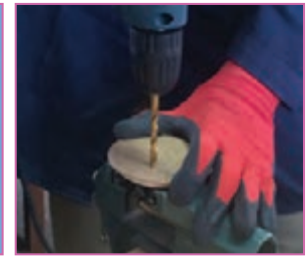
ث - سوراخ کاری قطعات
