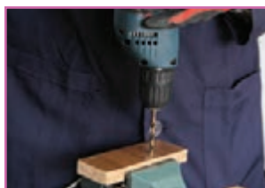
ب - سوراخ کاری قطعات
