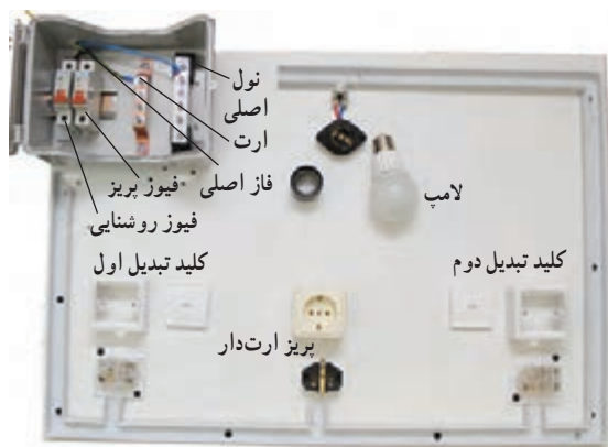
شکل ۶-۲۰- جانمایی قطعات مدار کلید تبدیل
